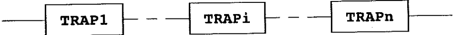
fig. 1.1 : REALISATIE VAN EEN HOGER ORDE FILTER ALS EEN KASKADESCHAKELING VAN 2DE ORDE TRAPPEN
