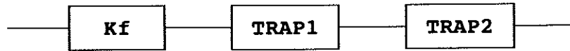
fig. 1.2 : REALISATIE VAN EEN HOGER ORDE FILTER ALS EEN KASKADESCHAKELING VAN 2DE ORDE TRAPPEN
